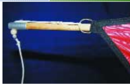
Das Prinzip der Spannvorrichtung an den Außenstäben
