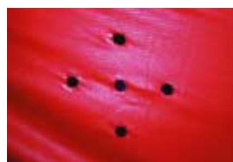
Löcher in den Segeln werden mit Textilkleber verstärkt
