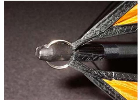
**3. Gestänge einpassen:** Einen 10mm Cfk-Stab in den Tunnel einschieben und auf die obere Spitze die 10mm Exel-Pfeilnocke aufsetzen. Hier den Schlüsselring einhängen. An das untere Ende kommt die 10mm FSD-Nocke. Mit einer Waageschnur die
