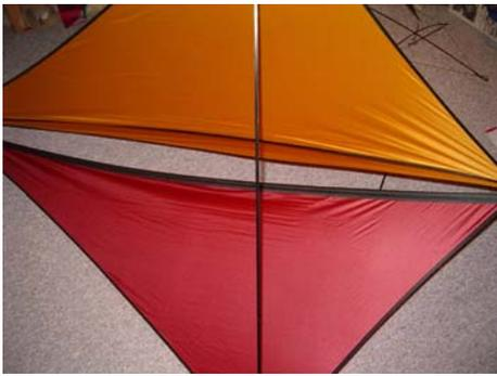
Segel spannen. Der Cfk-Stab darf eine leichte Durchbiegung besitzen.
